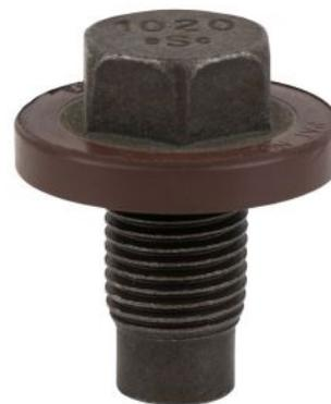
**Code OEM** 6035417**Code EAN** 4042146599259**Profil 1** 6 pans extérieur**Profil 6 pans extérieur de la vis** 16,0 mm**Taille du filetage** 1/2"UNFx1,25x20 mm**Utilisation (marque)** Chrysler**Pièces dans le set** 10 pièces**Poids** 440 g
