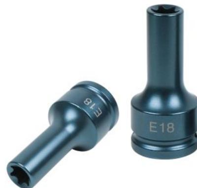
**Carré d'entraînement en pouce** 3/4"**Code EAN** 4042146653906**Longueur totale en mm** 90,0 mm**Matière** Acier Chrome Molybdène extra-fin**Norme** ISO 1174, DIN 3121**Profil 1** TORX-E®**Taille en TORX® E** E18**Poids** 285 g
