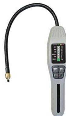
**Détection :** Acétone, Acétylène, Ammoniac, Benzène, Butane, Butanol, Chlore, Ethane, Ethanol, Essence, Hexane, Hydrogène, Hydrogène sulfuré, Isobutane, Méthane (naturel gaz), Méthanol, Acétate de méthyle, Chlorure de méthyle, Ether, Naphta, N-butane, Pentane, Propane, Propanol, Sulfer Dioxyde et Trichloroéthane
